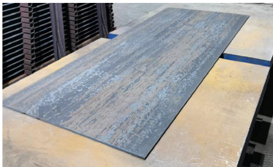
Рисунок 1 – Закалённый лист из высокопрочной стали размером 6×1250×3000 мм на инспекционном столе
